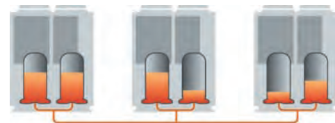
Tubería de equilibrado de aceite
